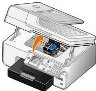
Il supporto delle cartucce di inchiostro viene spostato nella posizione di caricamento, a meno che la stampante non sia occupata.
